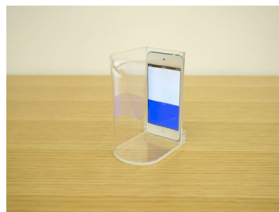
図1 Arctanbler：動的に入れる量が示される計量カップ
