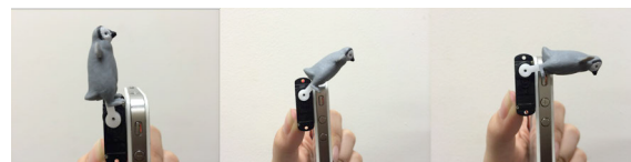
図 6 お辞儀の伝達装置の様子。左側：15 度のお辞儀の伝達、中央：30 度のお辞儀の伝達、右側：45 度のお辞儀の伝達。
