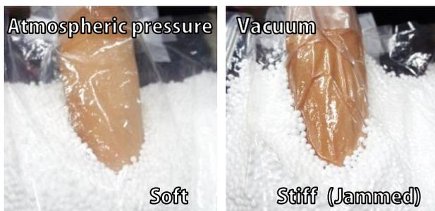
図 3 減圧による発泡ビーズの圧縮・硬化
