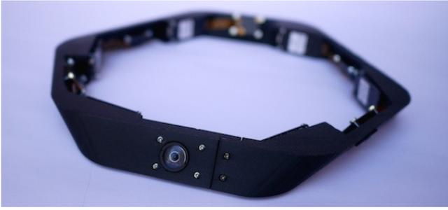
図 2 LiveSphere ヘッドギア：6台のカメラにより全周囲映像を記録する。
