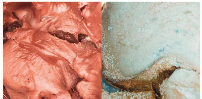
図2 銅+水性メジウムのインク(左)と銅+塩+水性メジウムのインク(右)それぞれ22日経過。
