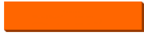
図 2 ピクセル立体のメニューバー (画像の右側と底辺に幅3ピクセルの影をつけた。)
