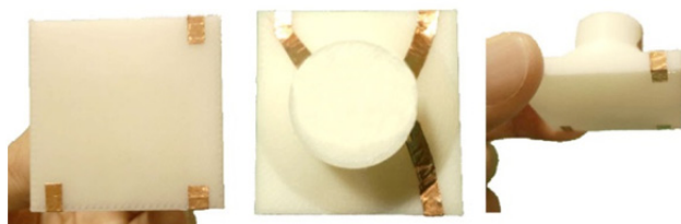
図 14 立体形状のつまみ. 左：底面，中央：俯瞰した面，右：側面. 底面に 2 次元コードを接着させていない状態。
