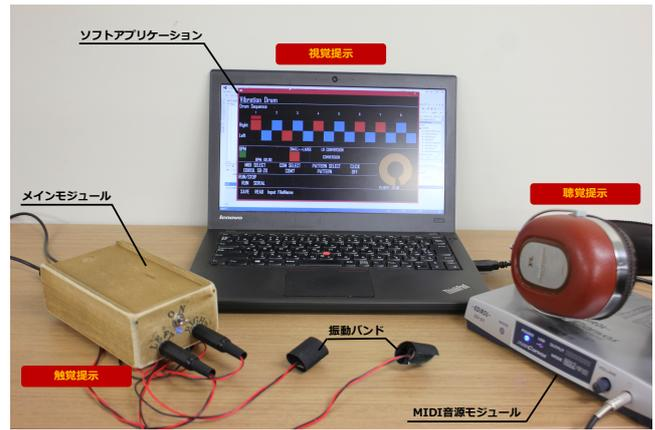
図 4 プロトタイプシステム
