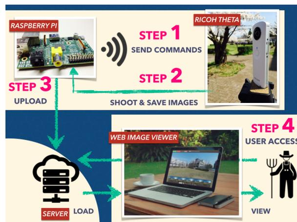
図 1 全天球モニタリングシステムの構成
