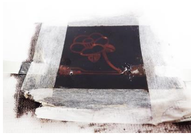
図5 剥離した直後の漆タッチインタフェース
