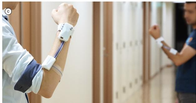
図 1 (a) 提案する運動覚インタラクションの概要: 運動覚帰還を基に相互に筋活動状況を知覚できる (b) 応用シナリオ: 蹴り出しタイミングの共有による歩行機能訓練支援, 神経筋疾患の伝達による介助者の理解の支援 (c) 開発した装着型デバイス
