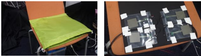
(a) デバイス外観 (b) 内部の圧力センサ
