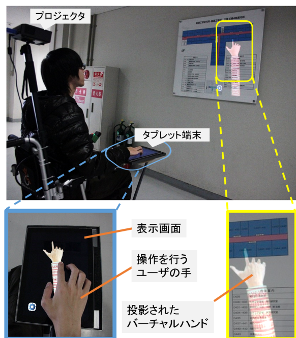
図 1 スタンドアローン型 ExtendedHand を車椅子に組み込み、使用した様子。タブレット端末をタッチするユーザーの手の状態と同期して、プロジェクタ投影されたバーチャルハンドが動作する
