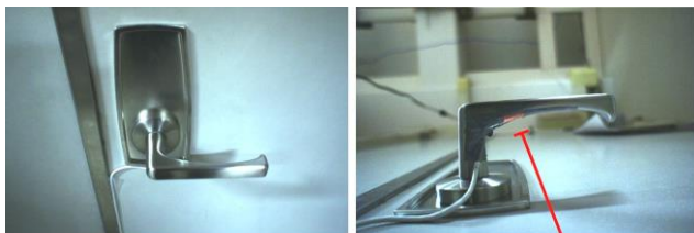
図 3 タッチセンサの電極を貼り付けたドアノブ (左, 正面から見たドアノブ 右, 下から見たドアノブ)
