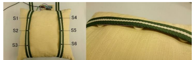
図 3 光センサモジュールをクッションに装着した様子
