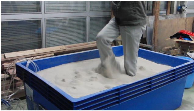
図 3 流動化した砂の中を歩く様子 Fig 3 Walking in fluidized sand.
