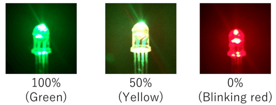
図 4: LED による残り時間表示
