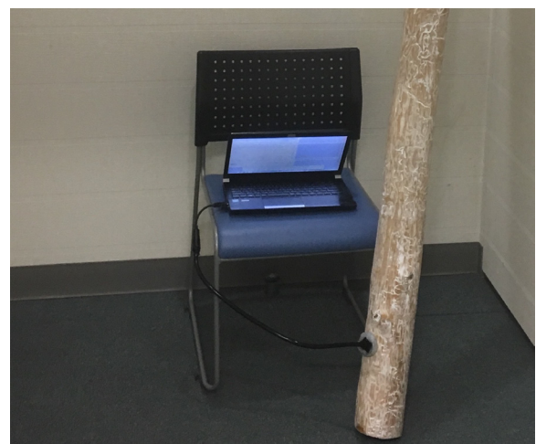
図 2: 利用した丸太と取り付けた聴診器
