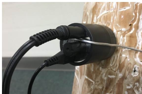
図 4: 簡易的にコンクリートマイクを取り付けた様子
