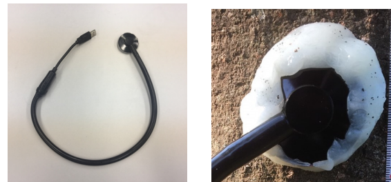
(a) USB マイクを取り付け (b) シリコン粘土付きチェストピース た聴診器
