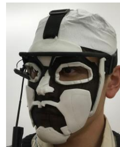
図1 試作した表情認識マスク Figure 1 Prototype of Facial Expression Recognition Mask
