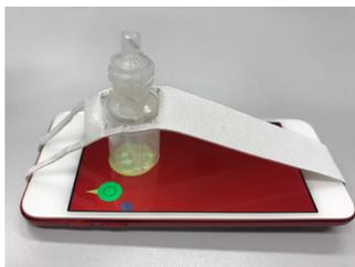
図6 バンドで点眼薬を固定した点眼支援ツール第二号
