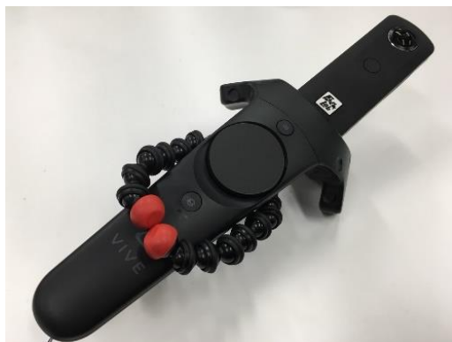
図2 VIVEのコントローラーにカメラを固定
