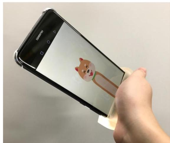
図1 スマートフォンと柔軟物を用いた握力測定方法
