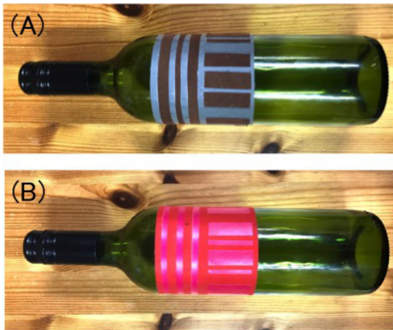
図 3 (A), (B) 試作した円筒マーカ; (A) 灰色の再帰反射材の上に茶色の布を貼付; (B) 再帰反射材とバー素材の色を合わせたもの。
