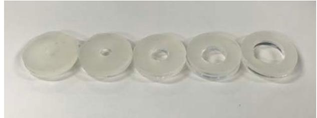
図 4 吸引径 (右から直径 4,8,12,16,20 mm)
