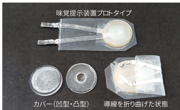
図 1 圧電素子を利用した味覚提示装置プロトタイプ（上）とカバー（凹型・凸型） 導線を折り曲げた状態（右下）。
