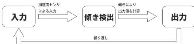
図 1 加速度センサを用いたシステムの遷移図 Figure 1 Transition Diagram of System using Acceleration Sensor
