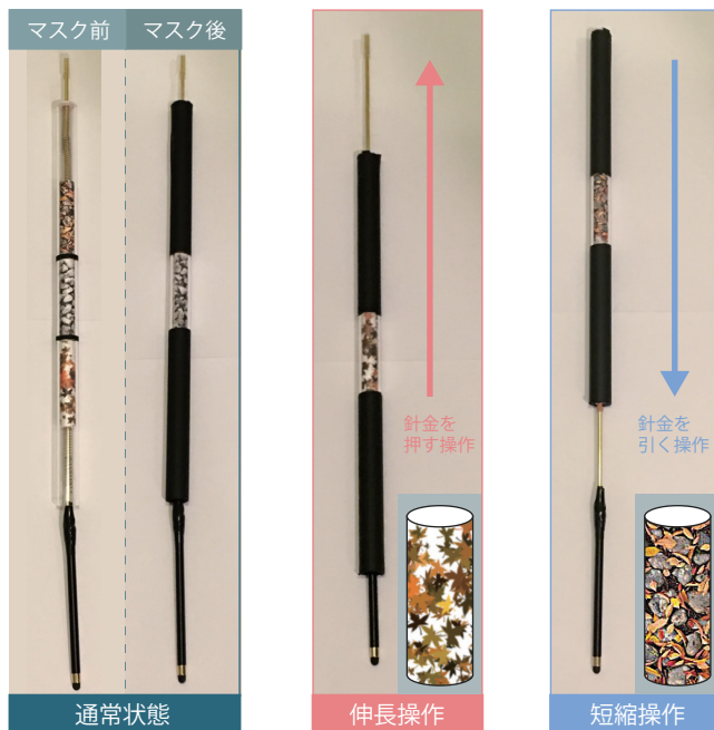
図 3 伸縮操作時における花軸デバイスのマーカの変化
