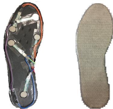
図 1 圧力センサ配置図, インソール表面図
