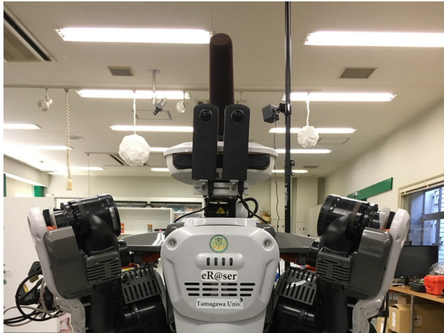
図 2 ロボットヘッドに取り付けた全方位カメラ
