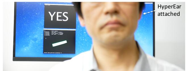
図 8 付与センサーによる頭部動作の認識: うなずき、首振りなどの微細な頭部動作が付与したジャイロ・加速度センサーにより認識する。音声を介さない返答が可能になる。
