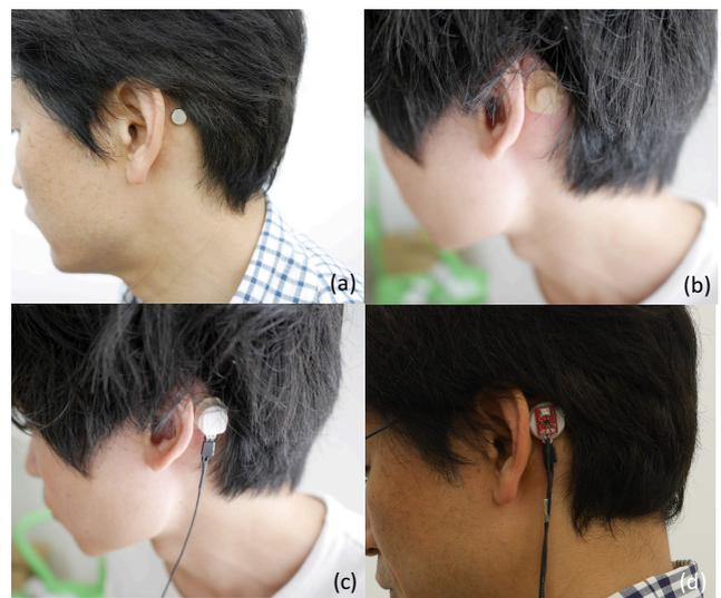
図 4 装着の様子: (a) 磁石を皮膚に接着. (b) 磁石を絆創膏で固定している状態. (c) コイル部を付与した状態. (d) マイクと同時に装着している状態
