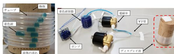
図 1 TuVe の概要 (左: ディスプレイ部にて文字 'イ' を表示したもの 右: システムの全体図)
