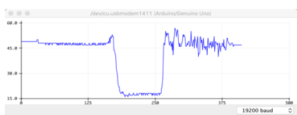
図4 コンダクターニットを強く引っ張る時と自由に押す時の電圧値変化
