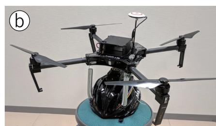
図 2: 歩行牽引デバイス（鉛直方式）
