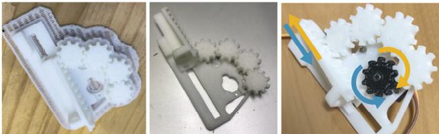
図6 サーボスライド。左：サポート材除去前，中央：サポート材除去後，右：サーボの回転方向とスライダの移動方向。
