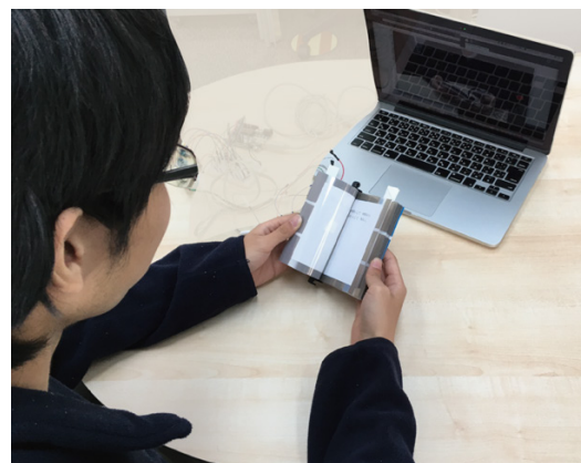
図1 提案システムの利用例。「ページをめくる」「本を支える」といった読書行為を、導電性インクを用いたタッチセンサで記録しつつ、動画と共に振り返ることができる。
