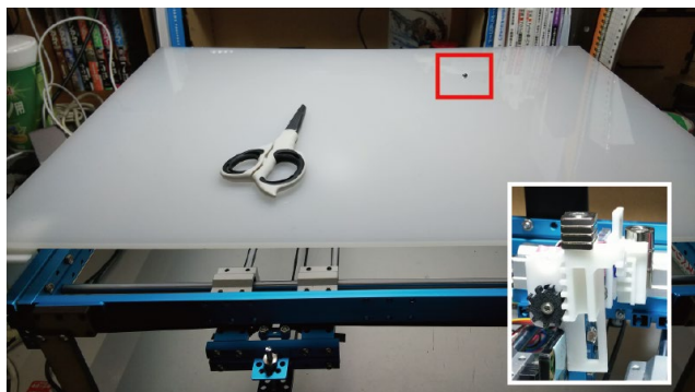
図10 弱い磁石での移動例。ハサミは移動せず、ネジだけが移動された。
