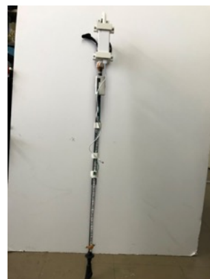
図 1 システムの全体の様子。ノルディックウォーキング用ポールの上部にモバイルバッテリーと Raspberry Pi Zero W, 中央付近に9軸センサ, 中央から下部にかけてLEDテープが取り付けられている。
