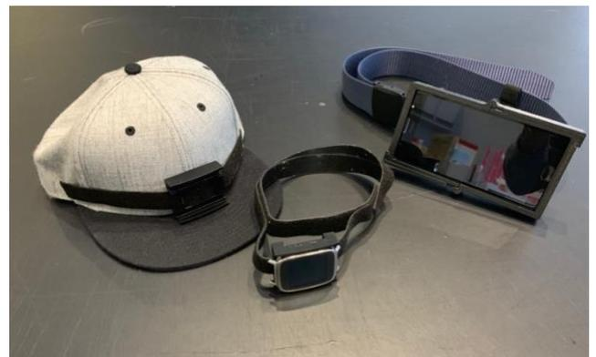
図4 スマートウォッチ(頭用/胸用)とスマートフォンの固定具
