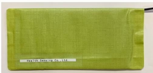
図 2 シート型圧電センサの外観
