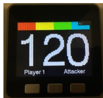
図 3 M5Stack のディスプレイを用いた情報表示
