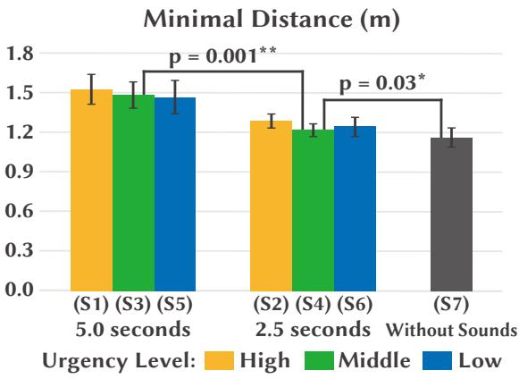
図 4: 各警告パターンにおける最接近距離の平均および 95%信頼区間.  $p$ : 最接近距離に対してマン・ホイットニーの U 検定を行なった際に得られた  $p$  値 (\*\* と \* はそれぞれ有意水準が 0.001 と 0.03 の時に有意差が得られた結果を示す).
