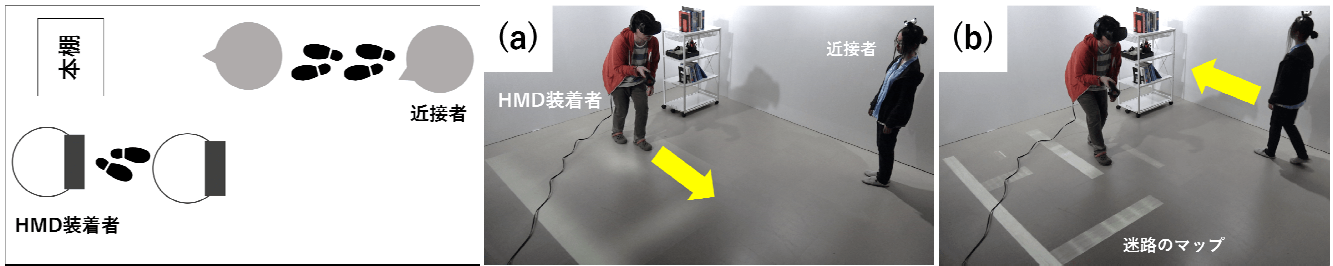
図 2 迷路探索：HMD 装着者の動く範囲を伝える手掛かり情報の例（床にマップを表示）
