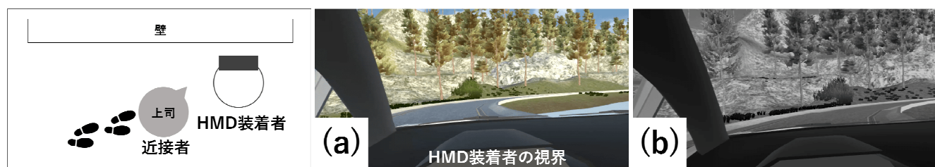
図 7 ドライブシミュレーション：上司が Danger zone まで近づいた時の手掛かり情報 ((a) 通常時の HMD 装着者の視界, (b) 白黒に変わった HMD 装着者の視界)
