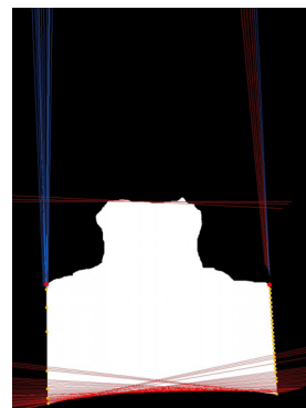
(1) 従来の実装（右端検出失敗） (2) 今回の実装（両端検出成功） 図 12 右边が曲がっている紙片画像からの破れ目の両端点の検出
