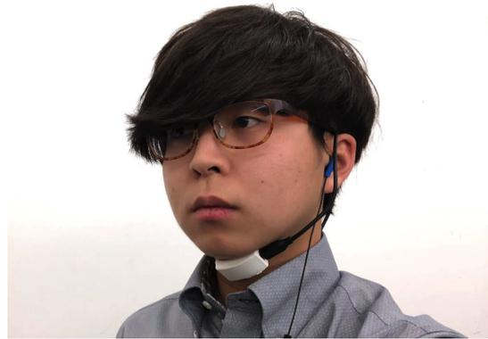
図 11 本研究を利用したウェアラブルコンピュータの想定図。咽頭に小型の超音波プローブを装着し、骨伝導または穴あきのイヤフォンを装着し、音を外部に漏らさずに音声エージェントと対話を行うことが可能になる。
