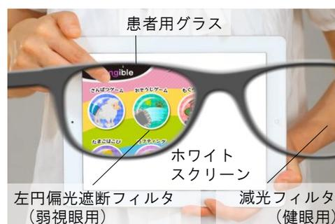
図 5 オクルパッドの構造
