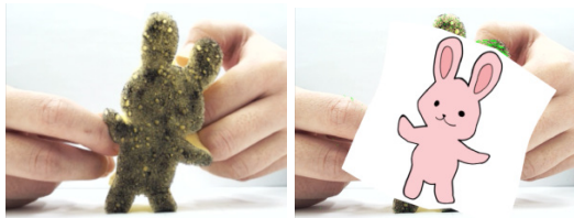
図 2 スポンジを動かして変形を入力する様子
