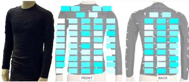
図 2 開発したセンサスーツ (左図) とセンサ配置 (中央, 右図)
