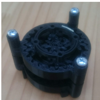
図 10 1:16 のギア比を持つ 2 重遊星ギアボックス
