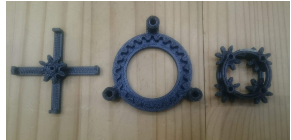
図 7 遊星ギアボックスの構成パーツ（太陽歯車、内歯車、遊星キャリア）
