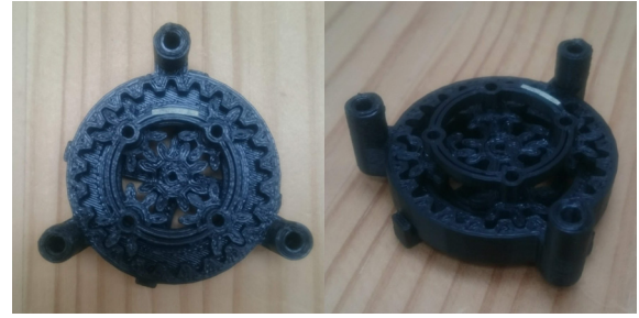
図 6 遊星ギアボックス（ギア比 1:4）
