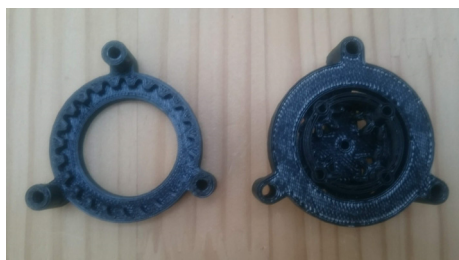
図 8 内歯車（左：上面，右：組み立て済みの底面）
