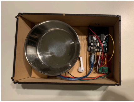
図 3 制作した餌入れの内部
