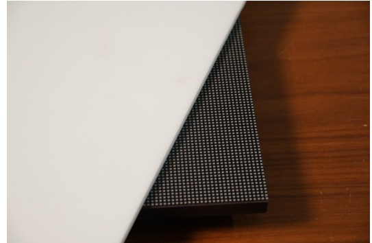
図 1 構成した人工大理石透過型 LED ディスプレイ
